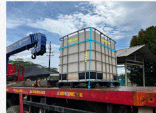
Dimensi IBC Tank P x L x T (120 cm x 100 cm x 115 cm) Berat Kosong ± 55 Kg dengan Kapasitas 1000 Liter / 1 Ton
